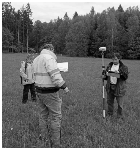
Geodetické práce při vytyčování půdorysů jednotlivých staveb Archeoskanzenu Trocnov.
